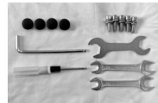
操作ハンドルの包装を外し、エネライド本体(背面付近)のネジ穴と合わせ、ネジを手で5箇所仮留めした後、六角レンチで本締めします。
