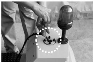
ドライバーで操作ハンドルのボルトを外してください。
