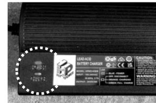
充電が完了したら、3極ソケットコードを抜く際に、上部のボタンを押しながら外してください。
